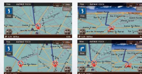
Vous pouvez sélectionner l'affichage 2D ou 3D et un affichage d'écran partagé en 2D + 2D ou 2D + 3D. Le guidage intelligent s'effectue en indiquant la position de votre voiture sur une incrustation où figurent les illustrations des intersections et des panneaux.
